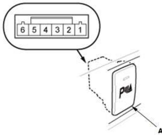
1. 根据表格检查驻车和倒车传感器开关 (A)。
